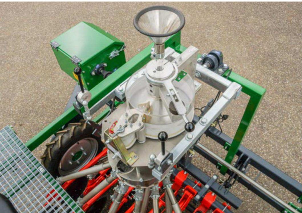
◀◀ Конический дозатор обеспечивает точное продольное распределение посевного материала.
