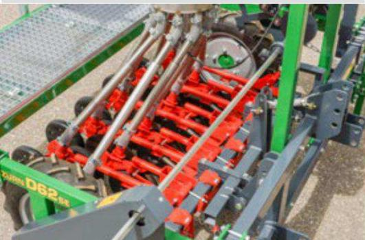
◀◀ ZÜRN D62-SE с дисковыми или анкерными сошниками может адаптироваться к различным условиям посева. Регулируемая балка сошников позволяет проводить простую регулировку давления на сошниках.
